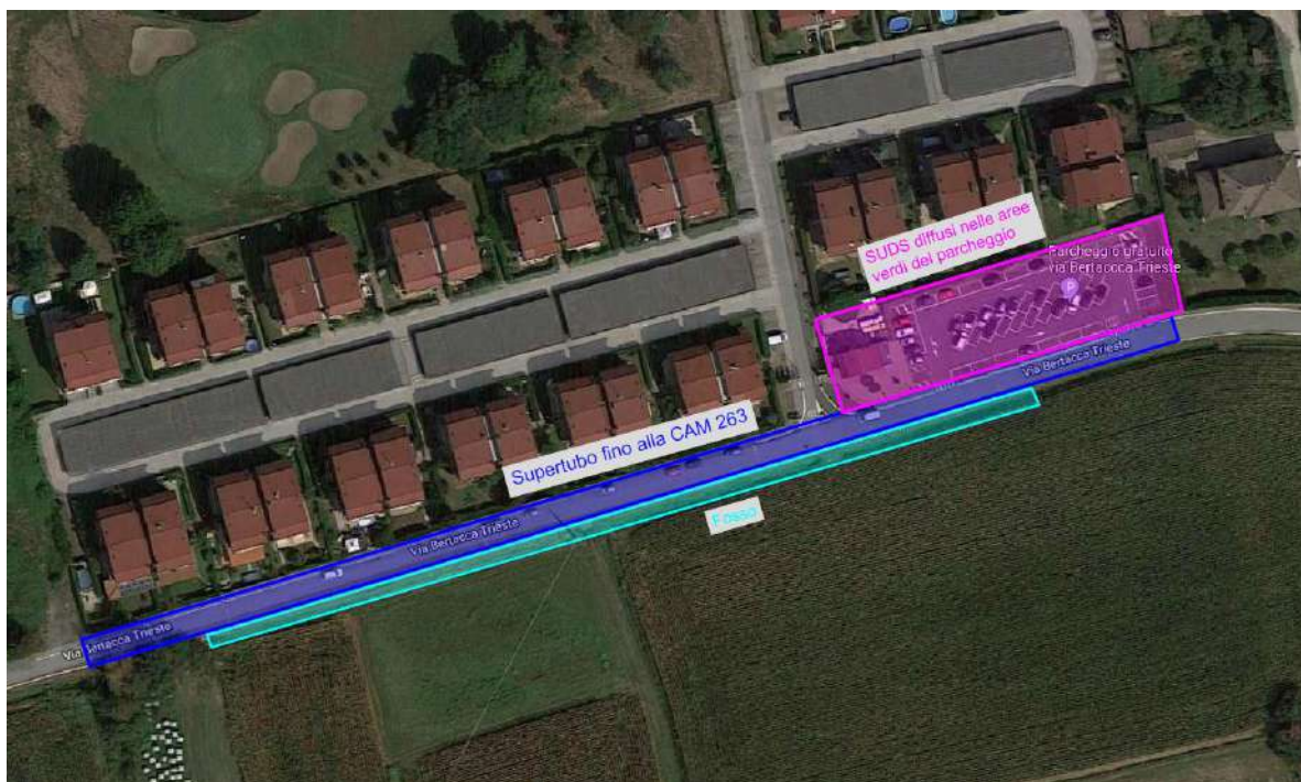
Figura 19 - Realizzazione supertubo in Via Bertacca Trieste e SUDS in area parcheggio
